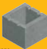
PH250 postiplokk 250 x 250 x 200 mm kulu 5 kpl/m mass 13 kg betoonikulu 36 l/jm
