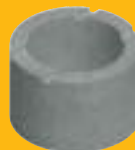
PPH300 postiplokk läbimõõt 300 x kõrgus 200 mm kulu 5 kpl/m mass 12 kg betoonikulu 45 l/jm
