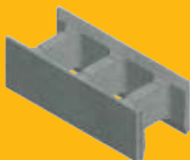
MH250 600 x 250 x 200 mm kulu 8,33 kpl/m 2 mass 23 kg betoonikulu 150 l/m 2
