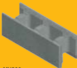
MH200 600 x 200 x 200 mm kulu 8,33 kpl/m 2 mass 20 kg betoonikulu 115 l/m 2
