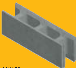
MH150 600 x 150 x 200 mm kulu 8,33 kpl/m 2 mass 18 kg betoonikulu 80 l/m 2
