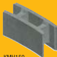
KMH150 400 x 150 x 200 mm kulu 12,5 kpl/m 2 mass 12 kg betoonikulu 80 l/m 2 sobib läbimõõduga 3-7 m
