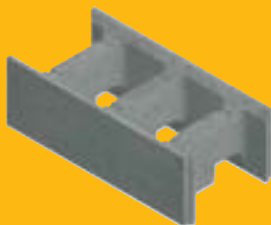
MH300 600 x 300 x 200 mm kulu 8,33 kpl/m 2 mass 25 kg betoonikulu 210 l/m 2
